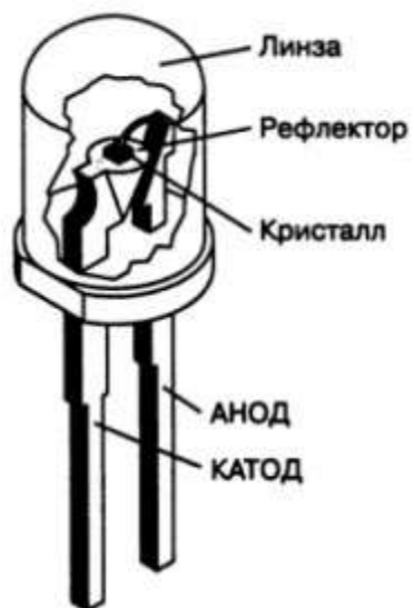
Рис. 6. Устройство светодиодов 5 мм. [19]
